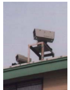
観察舎屋上に設置された遠隔操作長焦点・短焦点カラーカメラ
