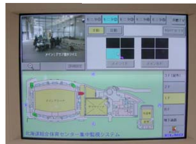
タッチパネル式 集中監視システム 操作画面
