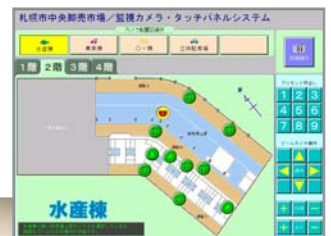
タッチパネルで 監視カメラを集中制御 3F機器室に設置した HDレコーダーの制御も 防災センターの パソコンで行なえます。
